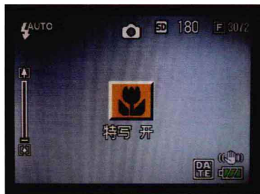
用小型数码照相机拍摄小件物品时，要切换到图标是花朵的微距拍摄模式
