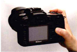
一些数码单反照相机在拍摄的同时无法从屏幕上进行画面确认。液晶显示屏是在拍摄完成之后确认照片时使用的
