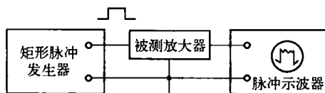
图 1.2 暂态法测试接线图
