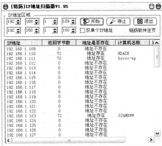
图 1-14 IP 地址扫描器操作界面
