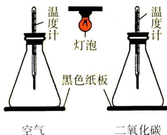
图 1-1 温室效应实验装置图
