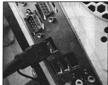
**操作：**将 USB 设备（如 USB 鼠标）数据连接线的一端插入主板 USB 端口中。
