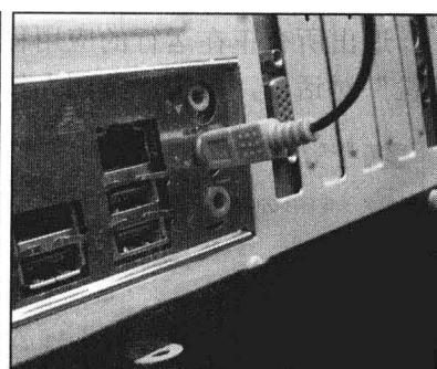
**操作：**将音箱或者耳麦的输入接头（一般为绿色）插入电脑声卡中的声音输出孔中（一般为绿色，在声卡所有插孔中间）即可。
