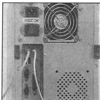
**操作：**将键盘接头插入主机背后的紫色接口中，将鼠标接头插入绿色接口中。
