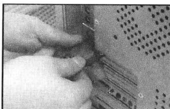
**操作：**连接显示器时，先把显示器信号电缆D形插头机箱后显卡接口连接上，然后将显示器电源线插入电源插座上。将显示器电缆插头接在显卡接口上，拧紧两边的螺丝。
