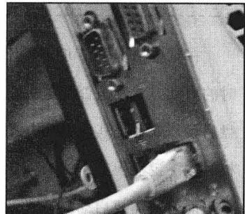
**操作：**如果需要连接网络，将网线的一端连接在电脑主机网卡插孔内，听见“咔”的一声表示线已经插好。注意网线插头上的卡扣方向，不要插反。
