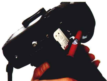
除去电池槽内的灰尘
