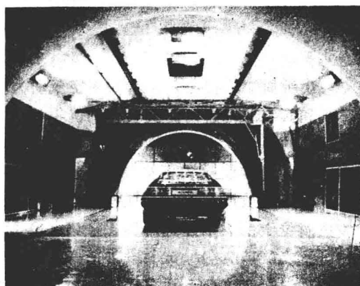
图1.5 平宁法里那风洞的试验段
