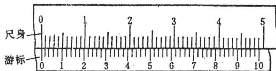
图 2-6 0.02mm 游标卡尺的刻度
