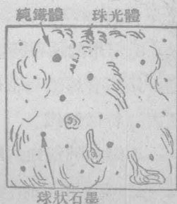
圖 4 球墨鑄鐵的金相組織
