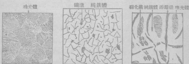
圖 1 0.85 碳鋼的金相組織 圖 2 熟鐵的金相組織 圖 3 灰口鑄鐵的金相組織
