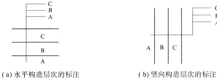
图 1-1 构造详图中构造层次与标注文字的对应关系
