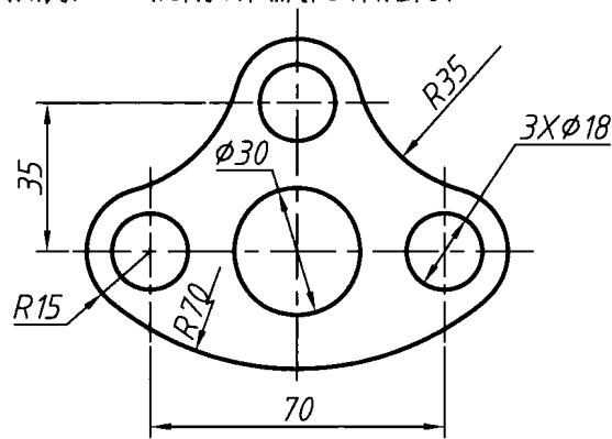
4. 将下面的图形按 2:1 的比例抄画在A3图纸上并标注尺寸。
