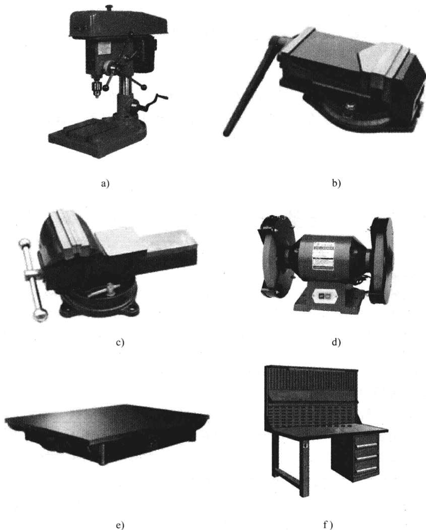
图 1-2 钳工实习场地中的主要设备
