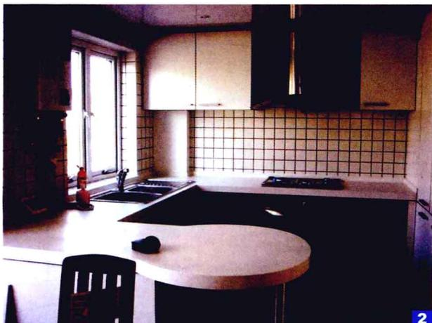
**1** 橱柜为防火板材质，台面为人造石材。施工做法为：柜体及台面为工厂定制，安装方法为现场组装。整体造价大约在22000元/整套。
