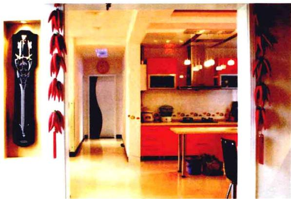
**1** 橱柜为西德板材质，台面为防火板，整体造价大约在11000元/整套。地面砖采用了水泥砂浆铺贴施工工艺，施工做法为：先将选好的地砖清洗干净后，放入清水中浸泡2~3小时后，取出晾干备用。之后排砖，当排砖确定后，应用方尺规方，每隔3~5块砖在结合层上弹纵横或对角控制线。然后开始铺砖，铺完一个区域后，压实并拔缝调直，最后用勾缝剂勾缝。整体造价大约在100元/平方米左右。
