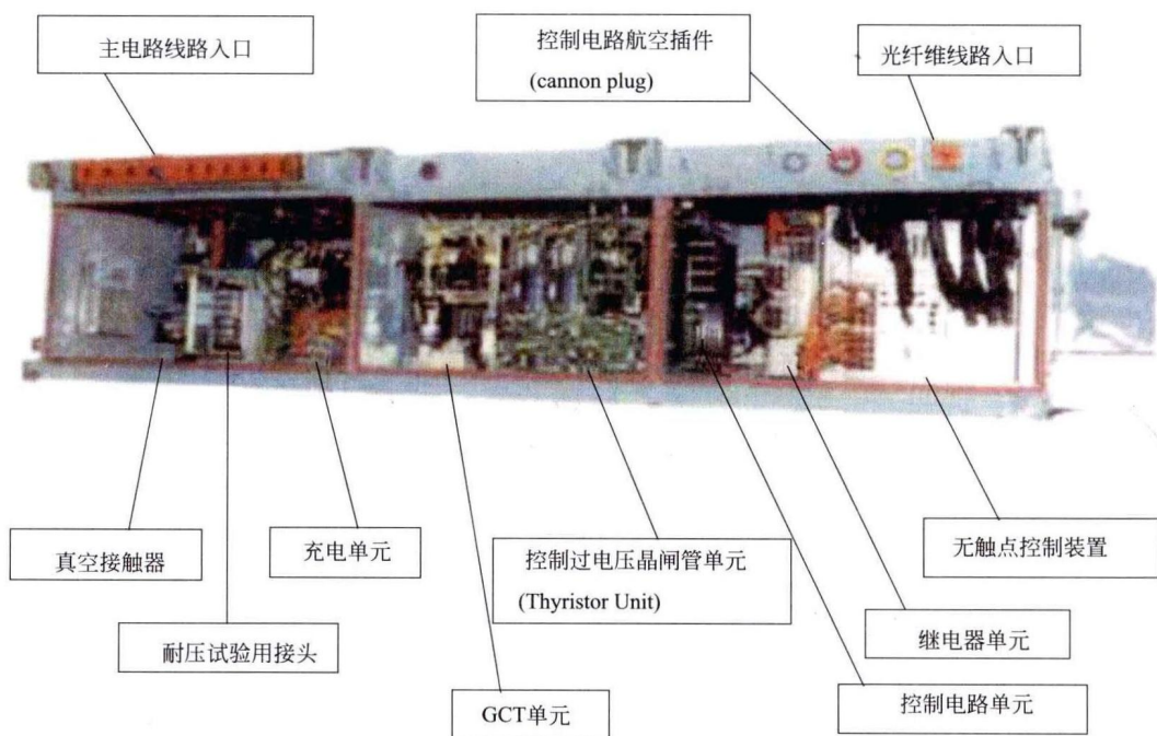
彩图 10 CRH2 牵引变流器实物图
