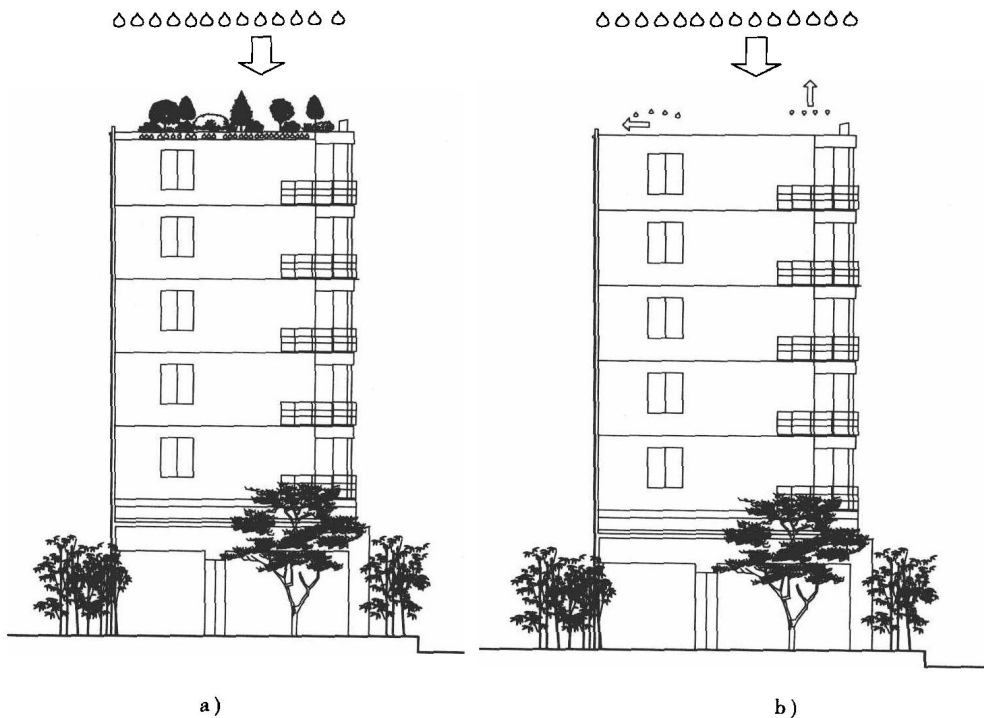
图 1-8 屋顶绿化滞留雨水
