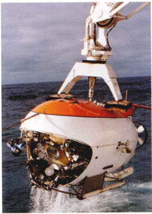
俄罗斯的潜水艇“米尔1号”被起重设备提出水面。它刚刚完成一次探查“泰坦尼克号”残骸的潜水航行。
