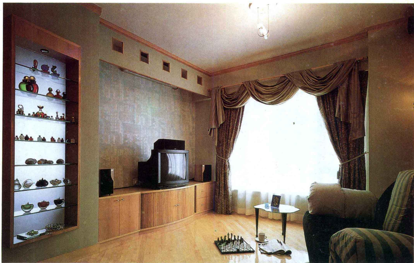
为使客厅更宽敞,将厨房隔墙外移,巧妙地置入电视机柜和陈列柜。后墙以壁纸装饰,顶上格内装有隐灯。陈列柜用毛玻璃作背板,借背面的光亮,使精致饰品更显光彩。
