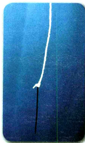
图十六 经过反复的浓盐水浸泡，棉 线已经吸饱了盐分，在棉线的外面形成一 层结实的盐壳
