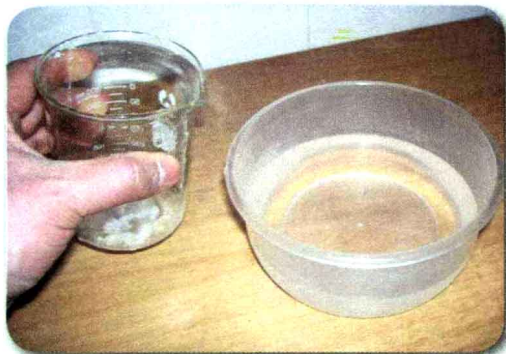
图十一 将过饱和乙酸钠溶液倒入干净的塑料盒
