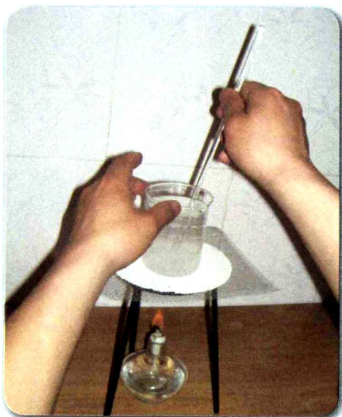
图九 在加热的过程中用玻璃棒不停搅动，使乙酸钠充分溶解
