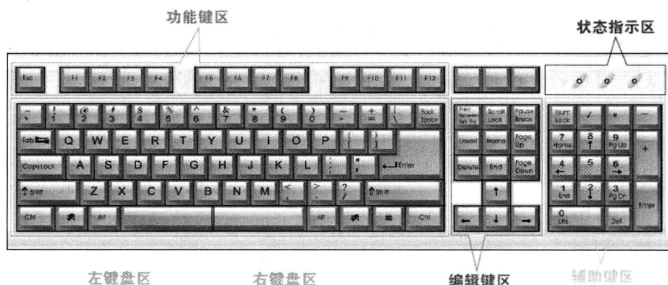
图 1.3.2 快易通中文速录键盘结构（左、右键盘区）
