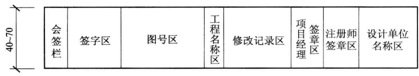
图 1-2 标题栏位于幅面右侧格式
