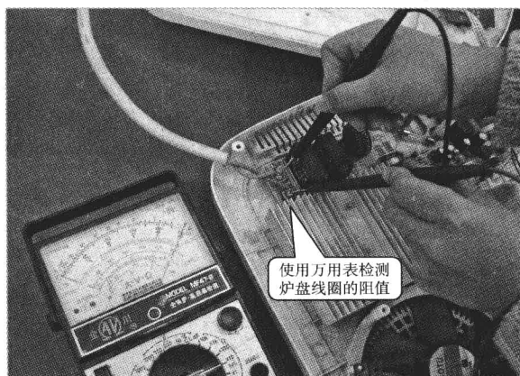
图 1-10 使用指针式万用表检测电磁炉中元器件的电阻值
