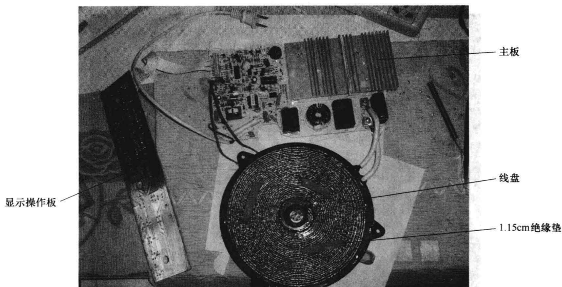
(a) 线盘、主板、显示操作板平放在工作台上
