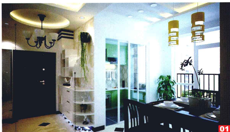
石膏板吊顶 密度板收纳柜
