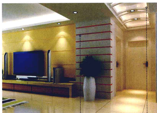
石膏板造型 · 石膏板吊顶
