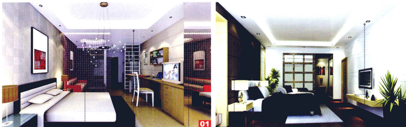
· 珠帘隔断 · 石膏板吊顶 · 镜面玻璃 · 软包背景墙 · 石膏板吊顶
