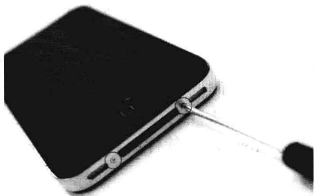
图1.8 取下底部的两颗螺丝钉
