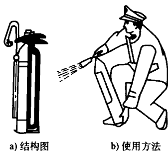
图 1-2 鸭嘴式二氧化碳灭火器的使用方法
