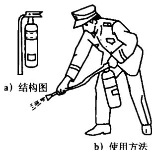
图 1-4 1211 灭火器的使用方法
