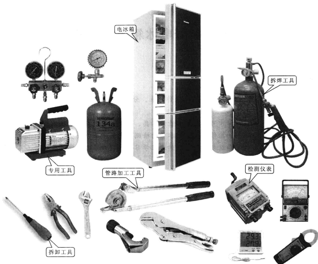
图 1-1 电冰箱的检修工具和检测仪表
