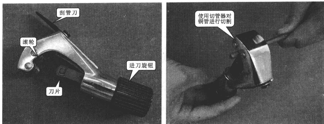
图 1-6 切管器的实物外形及使用方法
