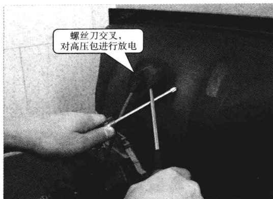
图 1-4 应用螺丝刀交叉方式对彩色电视机进行放电
