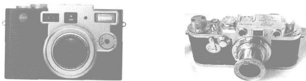
图1-2 纯机械的徕卡胶片照相机(右)与当今徕卡数码照相机(左)
