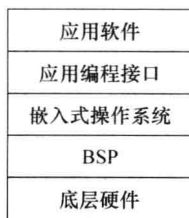
图 1.3 嵌入式系统软件层次结构
