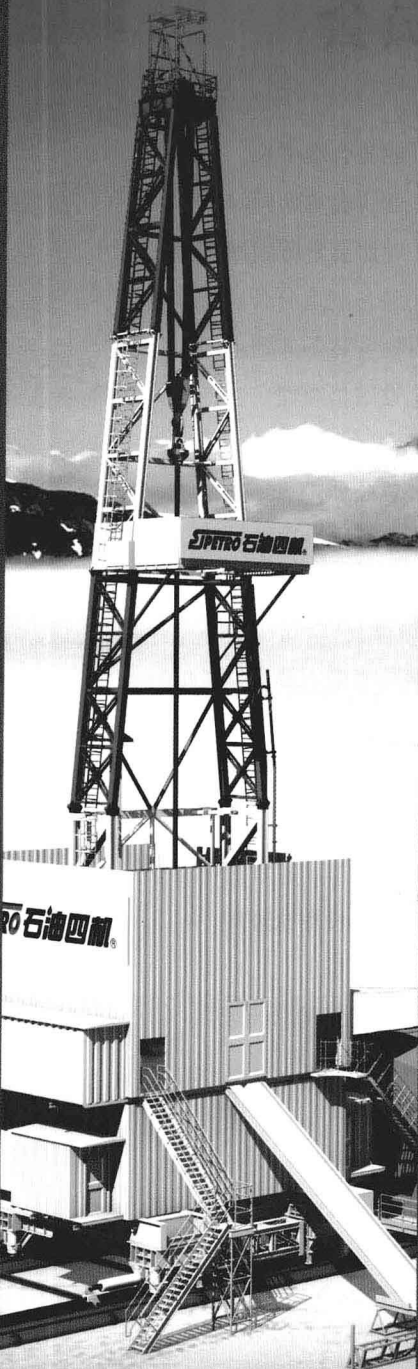
5000m低温轮轨电驱钻机
