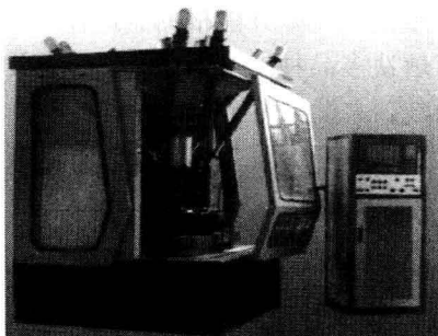
图 1-3 Stewart 平台结构与并联机床
