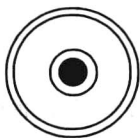
图 4-2 圆水准气泡在中心
