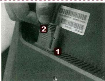
**1** 在显示器背部找到视频输出接口，将配套的显示信号线连接到该接口。
