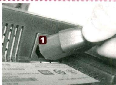
**1** 在显示器背部找到电源接口，然后将配套的电源线连接到该接口。
