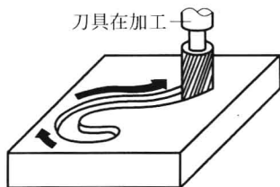
图 1.4 两轴联动加工
