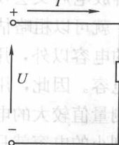
图 1—2 不含电源的部分电路
