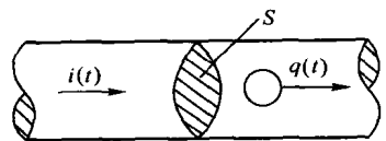
图 1-2 电流 i(t) 定义示意图
