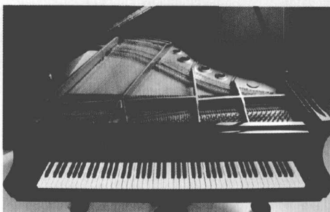
三角钢琴俯视图可以看到弦列、铸铁骨架、音板和键盘等结构。
