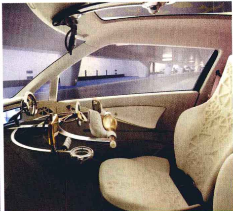
丰田 凭借 FT-EV II，丰田展示了丰田 iQ 未来的样子。这款小型电动车安装了滑移门，后部配有临时座椅，凭借锂离子电池，续航里程达 90 千米，最高时速可达 100 千米。金银丝细工特色的不带方向盘的操控元素在量产时不会被采用
