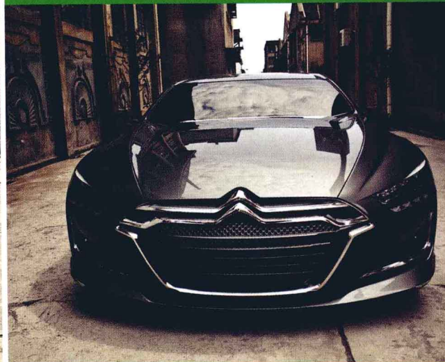
散热格栅后面的驱动系统拥有 4.0 升 V8 发动机的力量。雪铁龙大都会车身长 5.30 米，高只有 1.40 米
