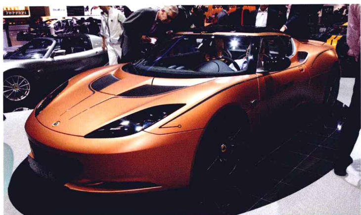
路特斯 一台 1.2 升的 48 马力汽油机作为增程发动机能确保埃武拉 414 E ( Evora 414 E ) 混合动力车的续航里程达 480 千米。短途行驶可以启用 17 千瓦时锂离子电池的能量，为后轴上的两台 152 千瓦电动机供电。可纯电动行驶 55 千米
