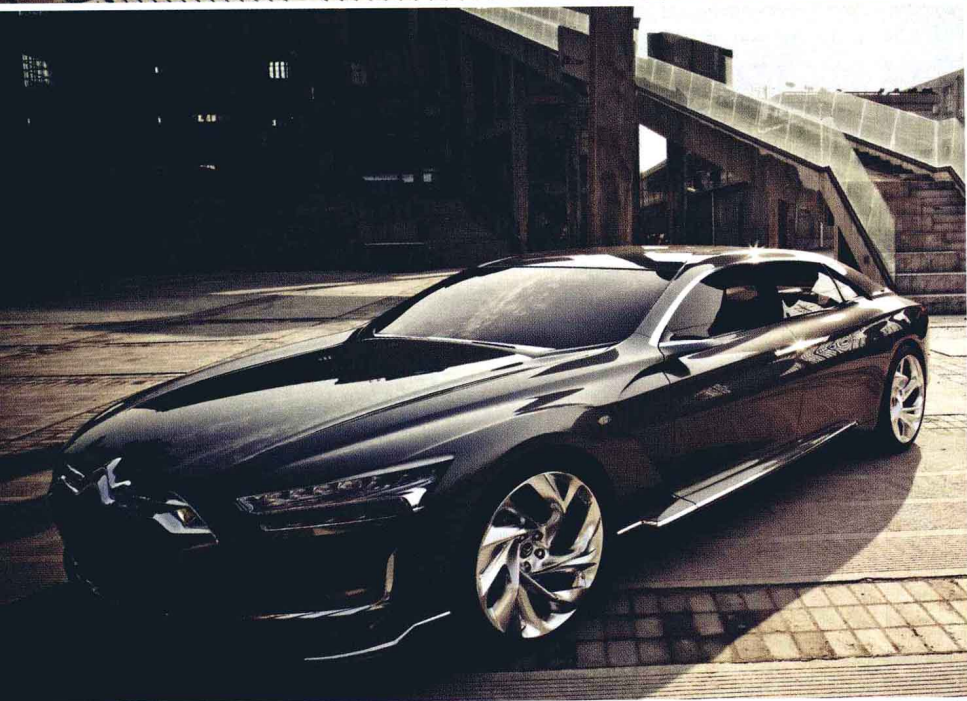
雪铁龙 气势雄劲的大都会 (Metropolis) 是一款强劲的混合动力车。272 马力 V6 发动机由一台 40 千瓦的电动机辅助
