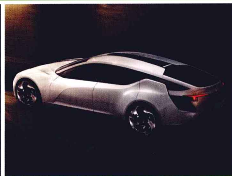
欧宝 向后打开的后门和极符合空气动力学的车身是欧宝飞灵 GT/E ( Flextrime GT/E ) 的标志。它的驱动系统和欧宝安佩拉 ( Ampera ) 类似。当 16 千瓦时的锂离子电池能量耗尽时，一台 1.4 升的汽油机作为增程发动机产生电能。最大续航里程 500 千米
