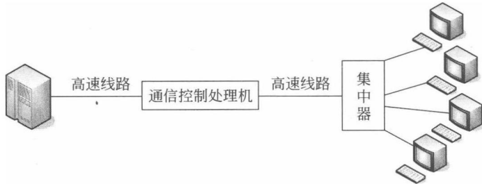
图 1-3 使用通信控制处理机和集中器的通信系统
