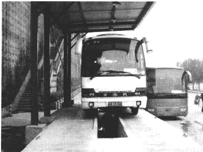
图 1-21 汽车维修地沟
