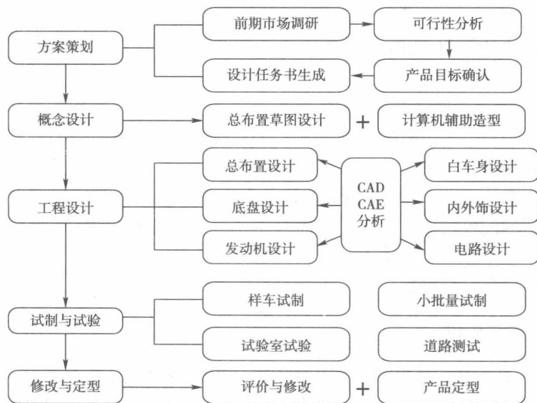
图 1-1 汽车设计程序图
