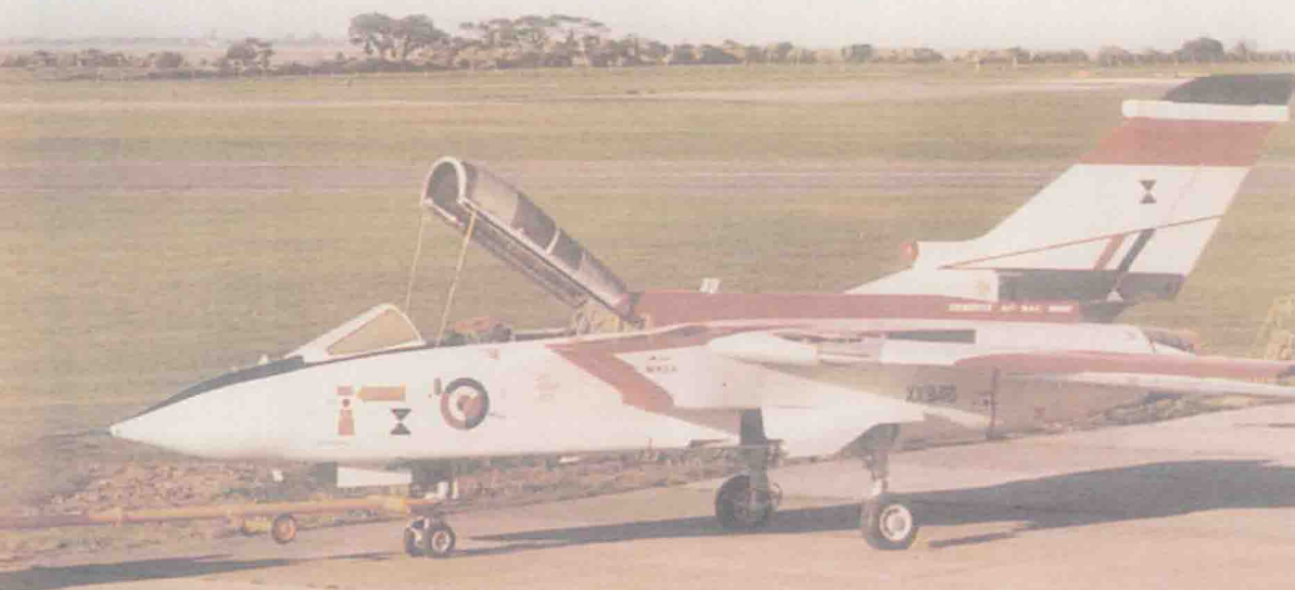
上图：“狂风”战斗机项目在多用途战斗机原型试飞前已开发得比较成熟。这一“海盗”战斗机是 2 架（XT272 和 XT285）装备了“狂风”战斗机雷达和航空电子设备的战机之一，其整流罩与“狂风”战斗机的几乎一模一样。
