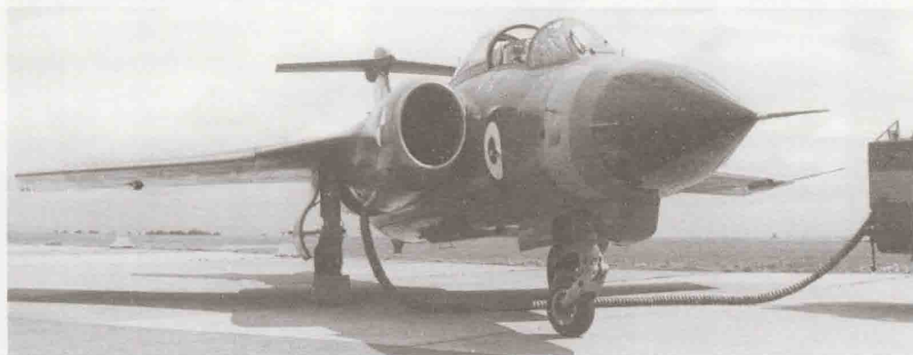
上图：“狂风”战斗机项目在多用途战斗机原型试飞前已开发得比较成熟。这一“海盗”战斗机是 2 架（XT272 和 XT285）装备了“狂风”战斗机雷达和航空电子设备的战机之一，其整流罩与“狂风”战斗机的几乎一模一样。
