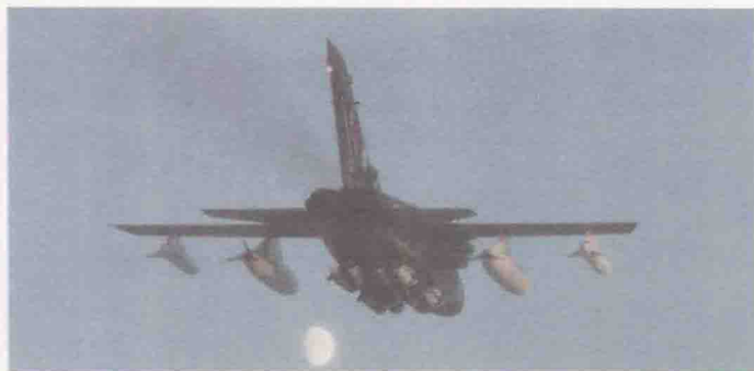
左图：狂风 06 号原型机，属于英国预生产的几架狂风中的一架。从图中能看出它能携带 8 枚 277 千克集束炸弹、2 个油箱和天空阴影电子对抗（ECM）吊舱。这架飞机是第一架原型机，它用来对 27 毫米毛瑟机炮的瞄准射击进行测试。
