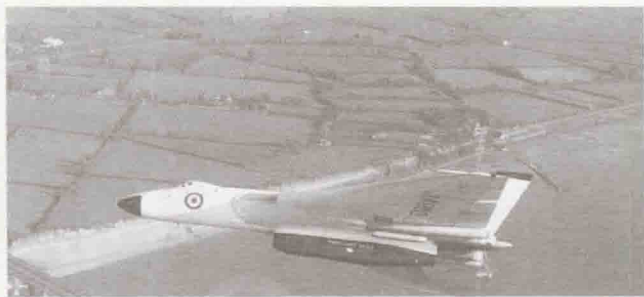
左图：“火神”轰炸机 XA903 被用来测试 RB 199 发动机，其机身与“狂风”战斗机相同，进气口和输送管也一样，右舷进气口之前的前机身外形也完全仿制了“狂风”战斗机。在最初几次飞行中该机左翼下带有一个检测仪表舱。
