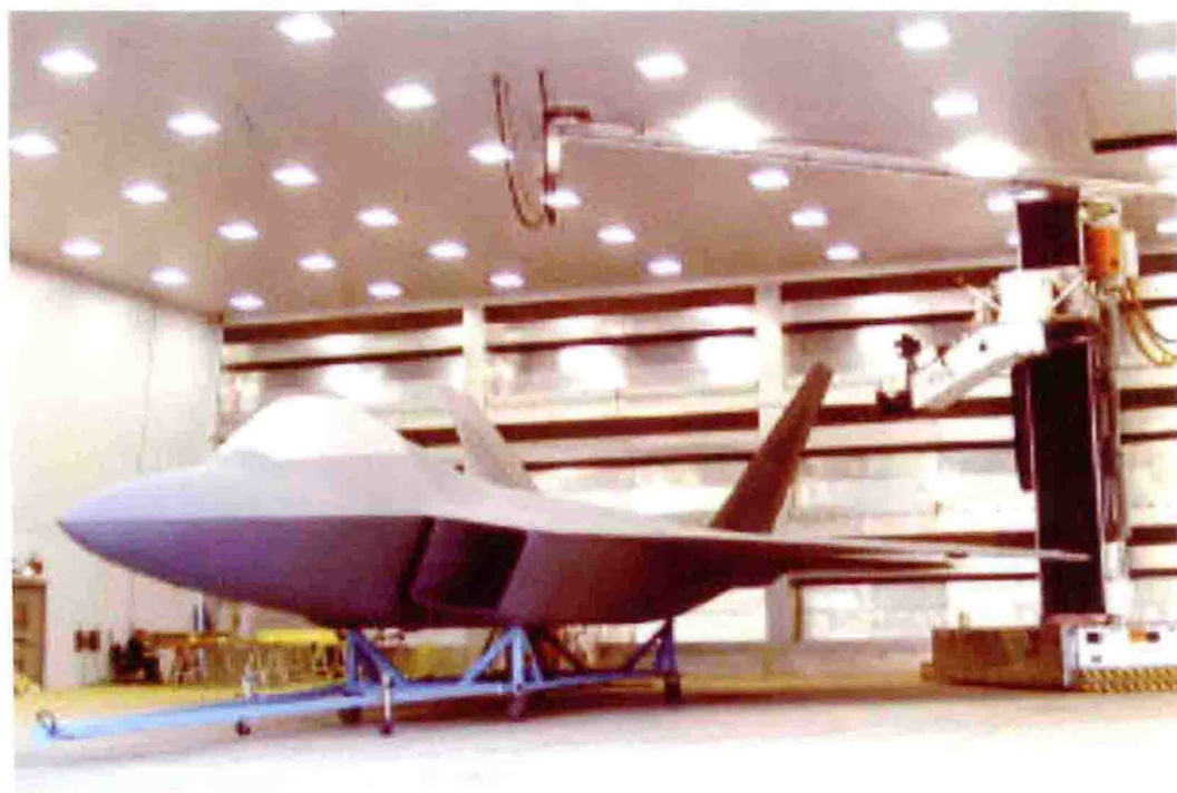
图 15 F-22 生产车间机器人喷涂设施
