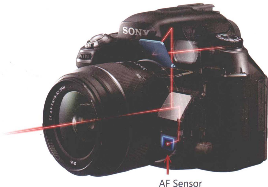
▲ 典型的单反相机入射光路
