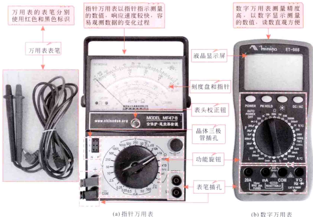
图 1-1 典型指针万用表和数字万用表的实物外形
