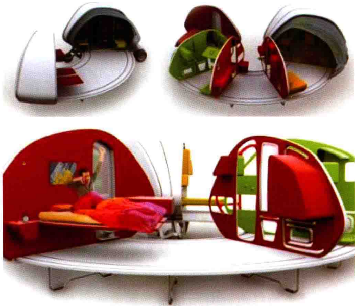
图2-7 这款名为“252°居住空间”的3轮拖车房出自富有创造性的法国设计师斯蒂芬妮·贝尔兰格（Stephanie Bellange）之手。由于个头很小，一辆Mini足以胜任拖拽工作。“252°居住空间”的突出特征是：一旦外壳打开，支撑脚便可自动展开，内部设施随后一一呈现在你的面前，就像是一朵盛开的花
