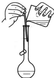
图 1-3 转移溶液到容量瓶中
