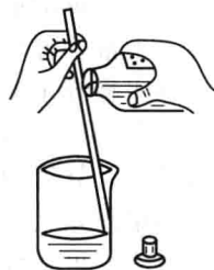
图 1-1 倾注法取用大量液体试剂
