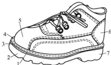
图 1-4 缝制沿条皮鞋
