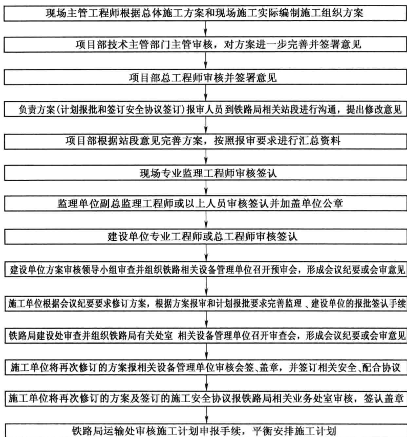
图 1-1-1 营业线施工方案报审流程图
