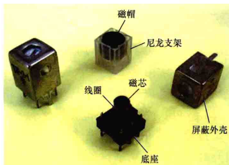
图 1-3 收音机常用中频变压器的构造
